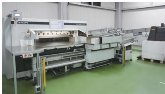
アプリシアCTX132は、基本の4方落としから短冊するまでを自動化。また、さまざまなパターンをプログラミングし、バーコードでジョブを呼び出せるようにすることで、自動と手作業を組み合わせている。
