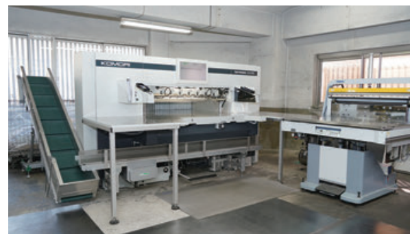
アプリシアCTX132にはオプションでエアージも搭載。現場からは「静電気で断裁刃にへばり付く薄紙が、エアージを搭載したことで自動的に落ちようになりました。刃も触らずに済み安全で、ストレスもなくなりました」
