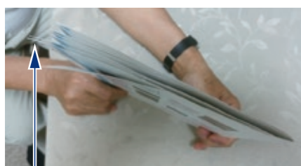
折丁の「出っ張り」。 これが大きすぎたり、まちまちだと、 無線綴じラインの中で折丁がそろいにくくなる。
