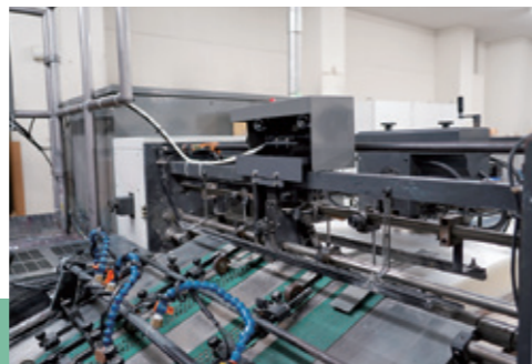
フィーダーに装着されたe-Mistは、印刷機が回っている時だけ作動する設定で、操作はオン・オフのみ。
