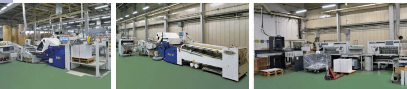
MBO K80(左)、MBO T800.1(中央)、アプリシアCTX115 2台とアンローダー(右)。「輪転からのシート出しをして、アプリシアCTX115に運び、断裁。そのままアンローダーでパレットに積み、パレットごとMBO K80に挿入。ラウンドフィーダー搭載のMBO T800.1は、枚葉の製品が厚い紙の場合や、輪転機で折り出したものを再加工する場合などに使用。この2台構成で、95%の折り作業を処理できています」(北川工場長)
