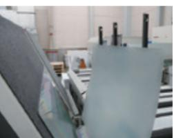
CTPトランスポーターが印刷機別に刷版を自動仕分けしてスタックしていく。
