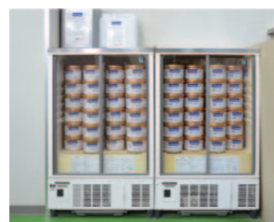
上: K-サブラインキ「KG-911」を、改造したビール用の冷蔵庫に入れて22°Cで管理。常にベストな状態に。 左: H-UV搭載リスロン S32 (四六半裁4色機) が、時短、経費削減、スペース削減などに寄与している。
