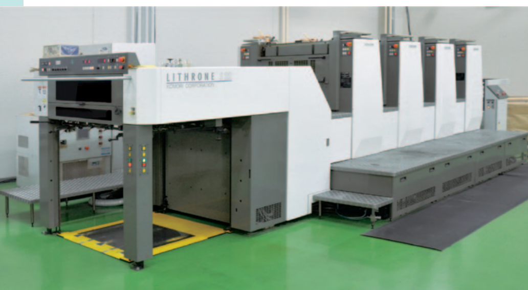
上: K-サブラインキ「KG-911」を、改造したビール用の冷蔵庫に入れて22°Cで管理。常にベストな状態に。 左: H-UV搭載リスロン S32 (四六半裁4色機) が、時短、経費削減、スペース削減などに寄与している。
